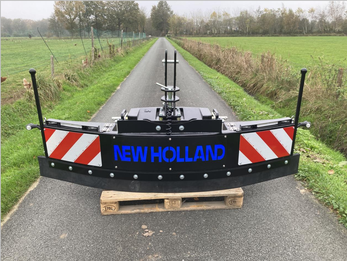
Gewicht-bumper zwart met zwart frontgewicht. Totaalgewicht \pm 850 kg.
